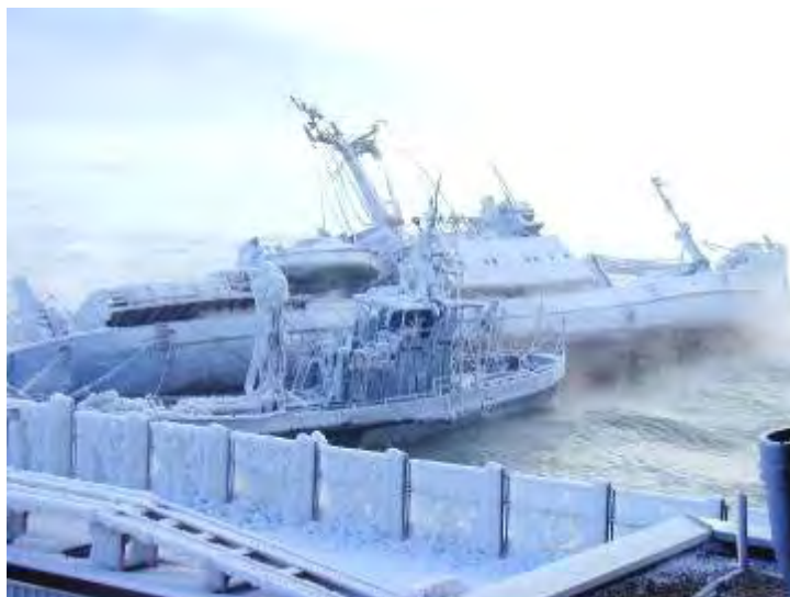
Рис. 1. Обледенение ГС «Арктика» и БГК-775. За несколько часов до потери устойчивости
